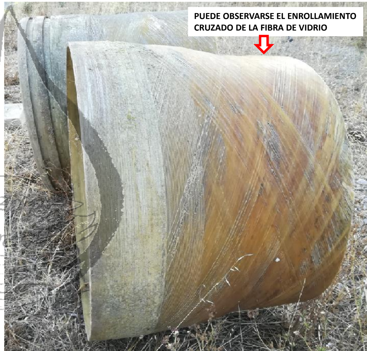
PARTES DE INSTALACIÓN DN800PRFV (EXTREMO Y CAMPANA) EXTRAÍDOS POR REFORMA TRAS MUCHOS AÑOS, SIN PRESENCIA DE NINGÚN TIPO DE DAÑOS
