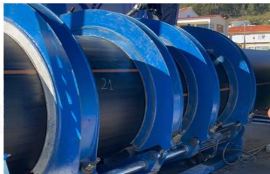
BANCO PARA ALINEAMIENTO TOTAL DE LOS TUBOS A SOLDAR
