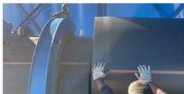
BANCO PARA ALINEAMIENTO TOTAL DE LOS TUBOS A SOLDAR
