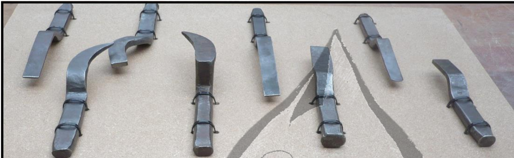
RETACADORES PARA LA COMPACTACIÓN DE LAS JUNTAS DE PLOMO DE LAS TUBERÍAS Y ACCESORIOS DE FUNDICIÓN GRIS, E INTRODUCCIÓN DE MÁS PLOMO, PARA PARAR LAS FUGAS
