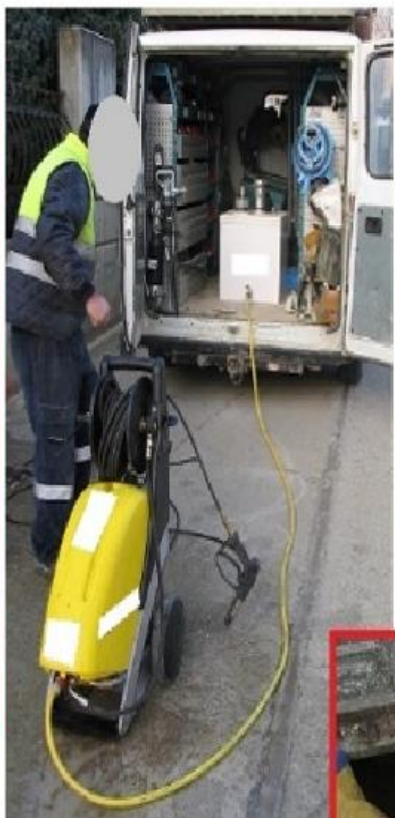
carga de agua caliente de caldera (60-70º) a tanque isoterma móvil
