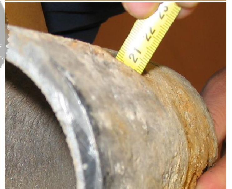
CORROSIONES EN TUBERÍAS DE FUNDICIÓN NODULAR
