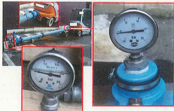
FIGURA 2. Contraste de presiones reales durante la prueba.
